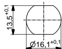
Minimale Wandstärke 1,5mm, alternativ Frontplattenausschnitt d=16,1
